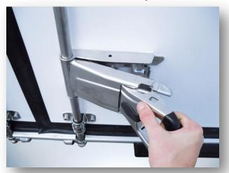
Pour faciliter l'ouverture et la fermeture, la liaison pêne – gâche a également été travaillée de façon à assister l'opérateur.
