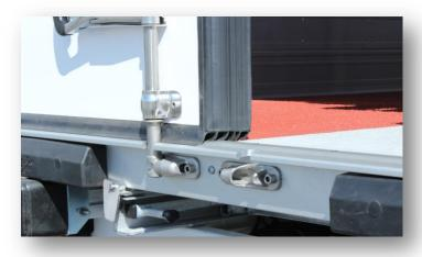
La conception des **nœuds d'assemblage des panneaux formant la caisse** a également été spécialement étudiée pour maximiser l'épaisseur d'isolation dans les angles (chaque panneaux se recouvrant à travers une bavette isolée) : ainsi aucune ligne de collage n'est « traversante » et aucun élément de fixation n'est métallique, afin de réduire à néant les ponts thermiques.
