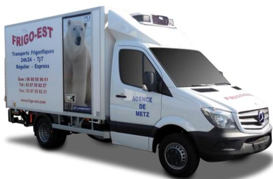
Un véhicule de dernière génération, optimisé pour réduire les émissions de CO2 : Groupe génératrice PULSOR, déflecteur, Profils aérodynamique avant CX System.
