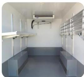
Cette carrosserie est destinée au transport sous température dirigée, en conformité avec la réglementation ATP en vigueur.
