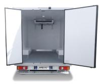
Cette carrosserie est destinée au transport sous température dirigée, en conformité avec la règlementation ATP en vigueur.
