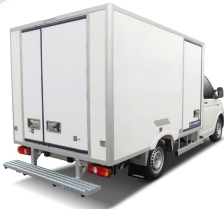
Cellule rabaisée type plancher-cabine avec passages de roues optionnels
