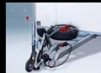
Accastillage de châssis (série) : Toutes les remorques sont dotées d'un accastillage complet : roue jockey pour faciliter les manœuvres ; 2 béquilles stabilisatrices à l'arrière et frein de parc pour l'usage statique ou le parking ; roue de secours et manivelle ; prise remorque 13 broches avec adaptateur 7 broches amovible.
