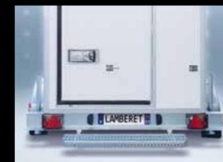
Marchepied : Intégré en version 750 kg ou rapporté au châssis en version 1300 et 2000 kg, le marchepied en acier fixe «1 niveau» antidérapant facilite l'accès à la zone de chargement.
