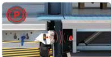
3. Rampa de embarque armada, etiqueta RFID visible, frenos bloqueados
