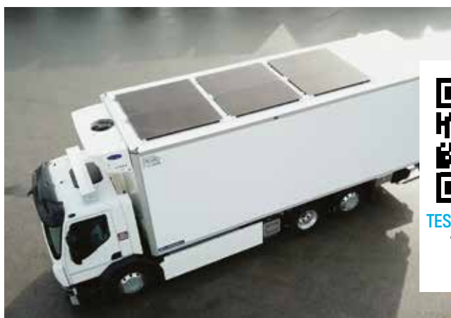
Lamberet ha equipado el techo de la carrocería con 6 paneles solares; una superficie total de 10 m 2 para un pico de potencia de 2400 W.
