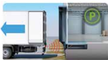
6. Rampa de embarque plegada, etiqueta oculta, liberación de los frenos. Seguridad en la salida supervisada por el automatismo
