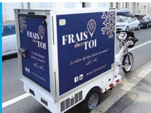
KLEUSTER Freegone cuenta con la nueva carrocería frigorífica con un valor K de 0,31 y un grupo frigorífico de frío positivo, plug & play.
