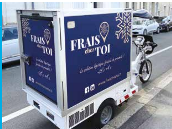
KLEUSTER Freegone è dotato della nuova cella Frigoline coefficiente K 0.31 e di un gruppo frigorifero in freddo positivo, plug & play.
