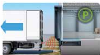
6. Rampa della banchina ripiegata, TAG nascosto, sblocco dei freni. Sicurezza della partenza controllata da un meccanismo automatico.
