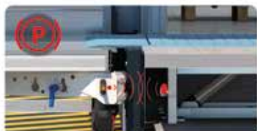
3. Rampa della banchina attiva, TAG RFID visibile, freni bloccati.
