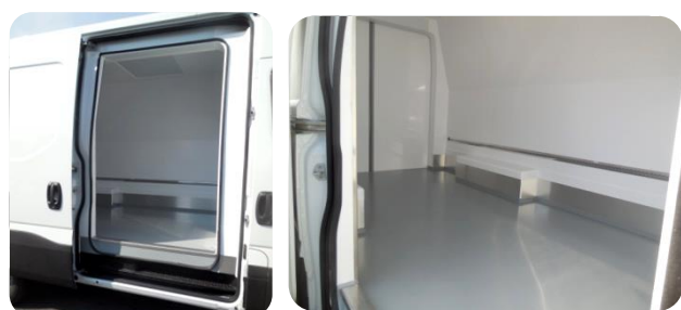
Porte latérale coulissante isolée avec double joint périphérique et seuil latéral marée
