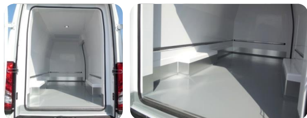
Plancher palettisable (monte simple) et protection de caisson de roue antichoc
