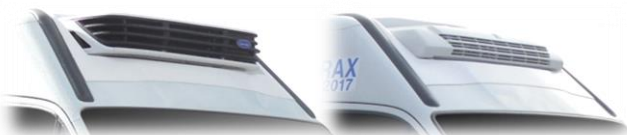
Groupes splités dans encastrement aérodynamique : CARRIER ; THERMOKING
