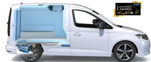
Groupe intégré sous-châssis Kerstner e-Cooljet 106
